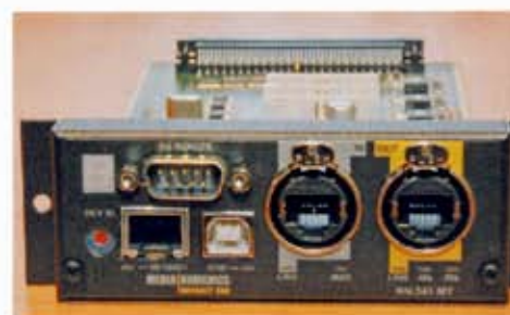
Die Front der RN.341.MY, u. a. mit HA-Remote-Schnittstelle, Drehregler und Anzeige zur Auswahl und Anzeigen eines Konfigurations-Presets
