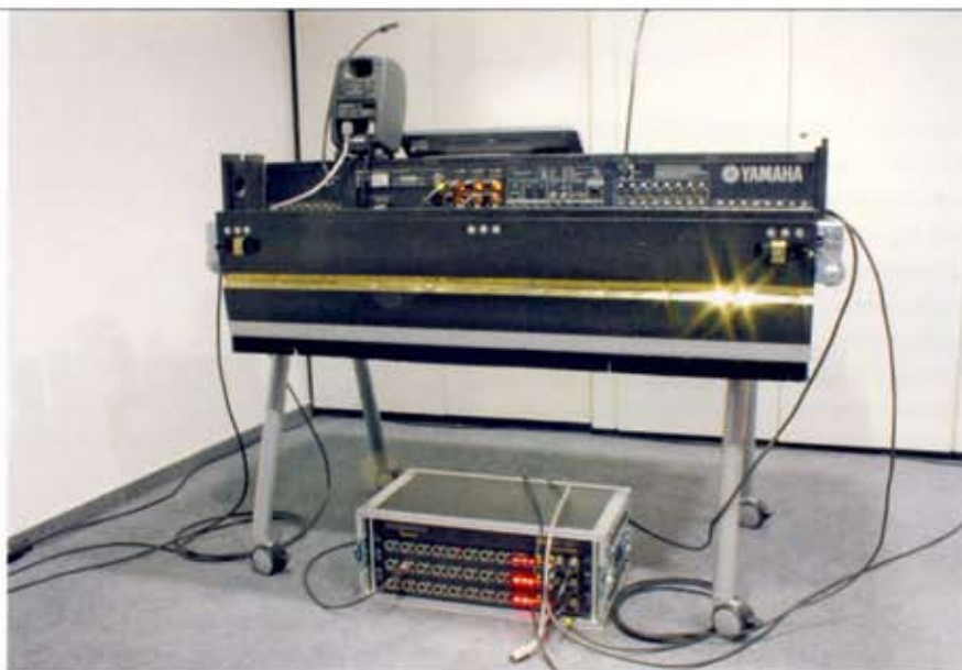
Das M7CL mit drei RN.341.MY und das Rack mit drei analogen Ausgangsmodulen (RN.302.LO) als lokale Ausgabepunkte am „Monitorplatz“
