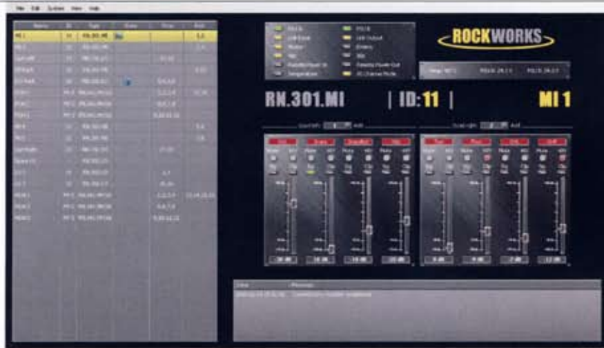
Abb. 1a: Die Software RockWorks. Links sind die Geräte im Netzwerk aufgelistet, rechts sind Status, Konfiguration und Kanalparameter des ausgewählten Gerätes angezeigt und können geändert werden. Die rote Darstellung der Namensfelder der Kanäle signalisiert, dass sich diese Mic-Preamps unter Kontrolle des Mischpults befindet und die Kanalparameter via Software nicht verändert werden können.
