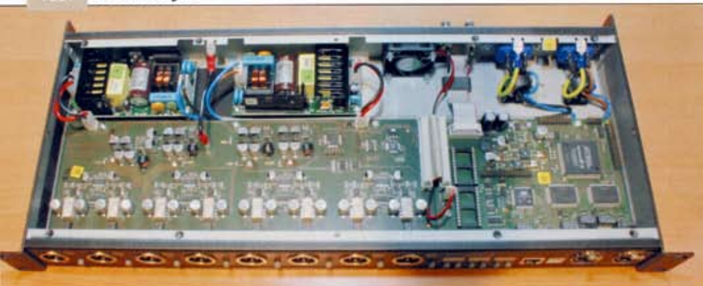
Ein RN.302.LO, das analoge Ausgangsmodul von innen
