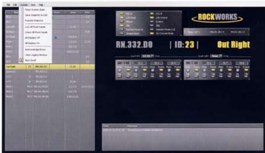
Abb. 2a: Unter „System“ lassen sich einige Parameter für das Gesamtsystem bestimmen. U.a. können Snapshots von der aktuellen Konfiguration gespeichert und später wieder geladen werden.
