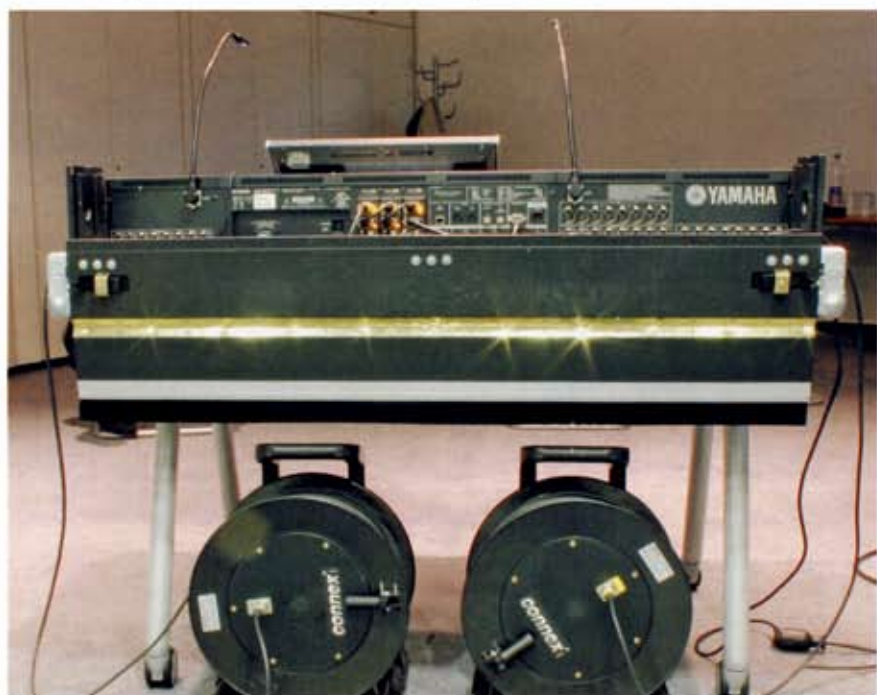
Das „FOH-Pult“ in unserem Testaufbau mit drei RN.341.MY und den beiden 150-m-Kabeltrommeln, die in das Netzwerk eingefügt waren
