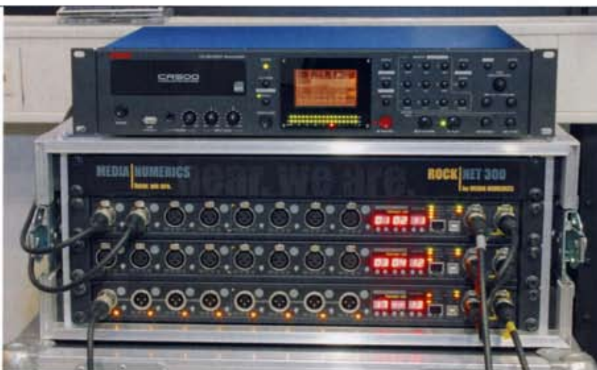
Eines der beiden „Bühnen-Racks“ unseres Aufbaus mit zwei Mikrofon-Modulen (RN.301.MI) und einem Modul mit ASE/EBU-Ausgängen (RN.332.DO)
