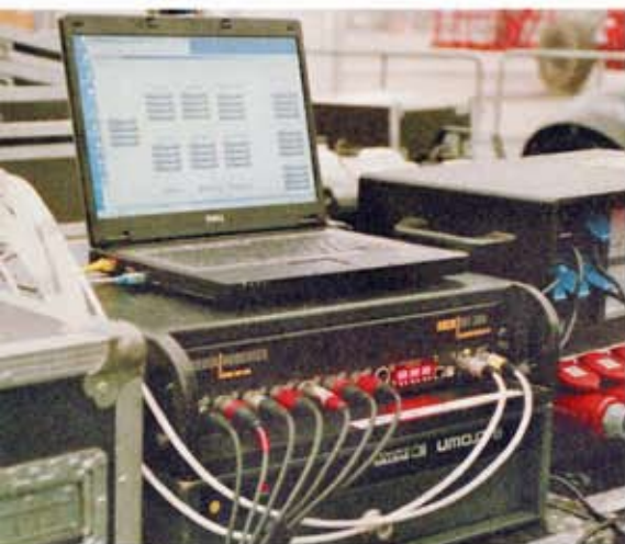
RockNet bei den Amp-Racks (PUR AufSchalke)
